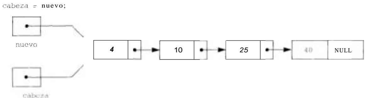
En este momento, la función de insertar un elemento en la lista termina su ejecución y la variable local `nuevo` desaparece y sólo permanece el puntero de cabeza `cabeza` que apunta a la nueva lista enlazada
