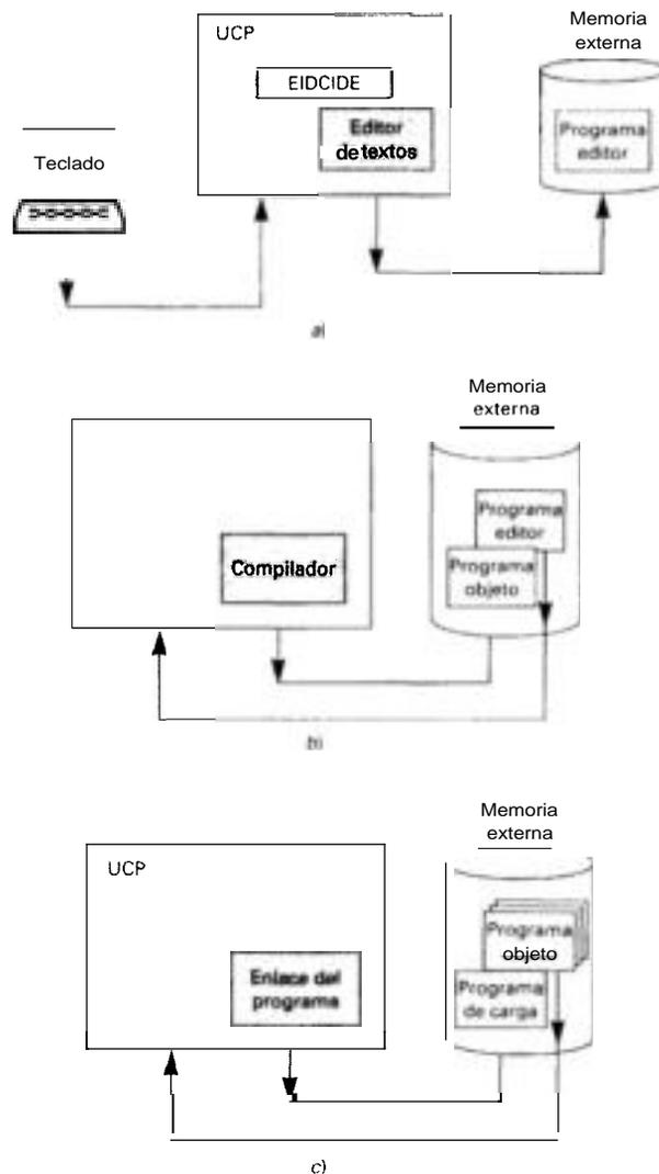
Figura 2.5. Fases de la compilación/ejecución de un programa: a) edición; b) compilación; c) montaje o enlace.
