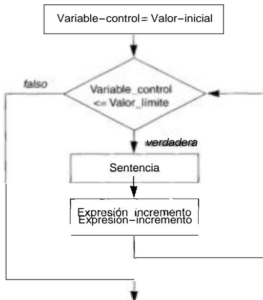
Figura 6.2. Diagrama de sintaxis de un bucle `for`
